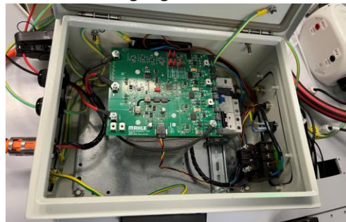
Fig. 15 Test Ansteuer-Elektronik mit in AP 3.3 erarbeitete Features
