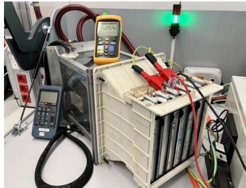
Fig. 14 Messaufbau mit der Heizelementaufnahme und der Medien Versorgung
