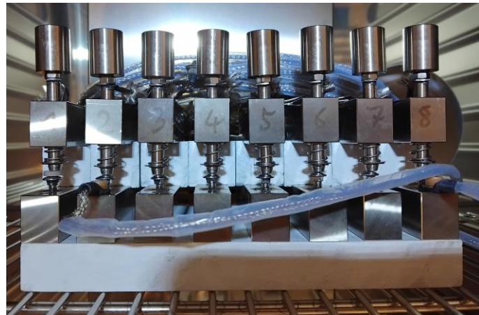
Fig.31: Probenhalter zur Bestimmung von „unloaded curves“
