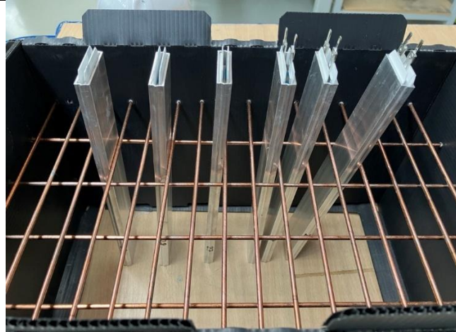
Fig. 13 Drei Heizelemente mit neuem Design (links) und drei Heizelemente mit Beschichtungsvariationen (rechts)
