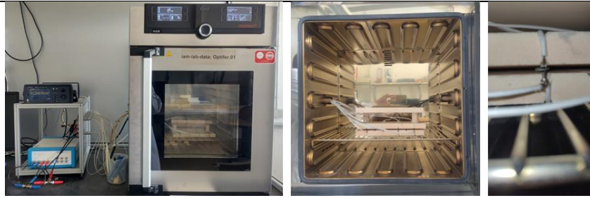
Fig. 37: Modularer Messplatz zur temperaturabhängigen Widerstands- und Impedanzmessung
