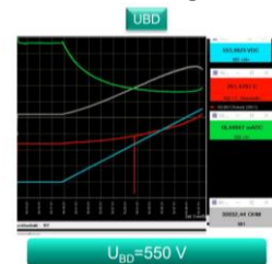
Fig. 44: HV und IR begleitete Messungen für die Plattegeometrie.
