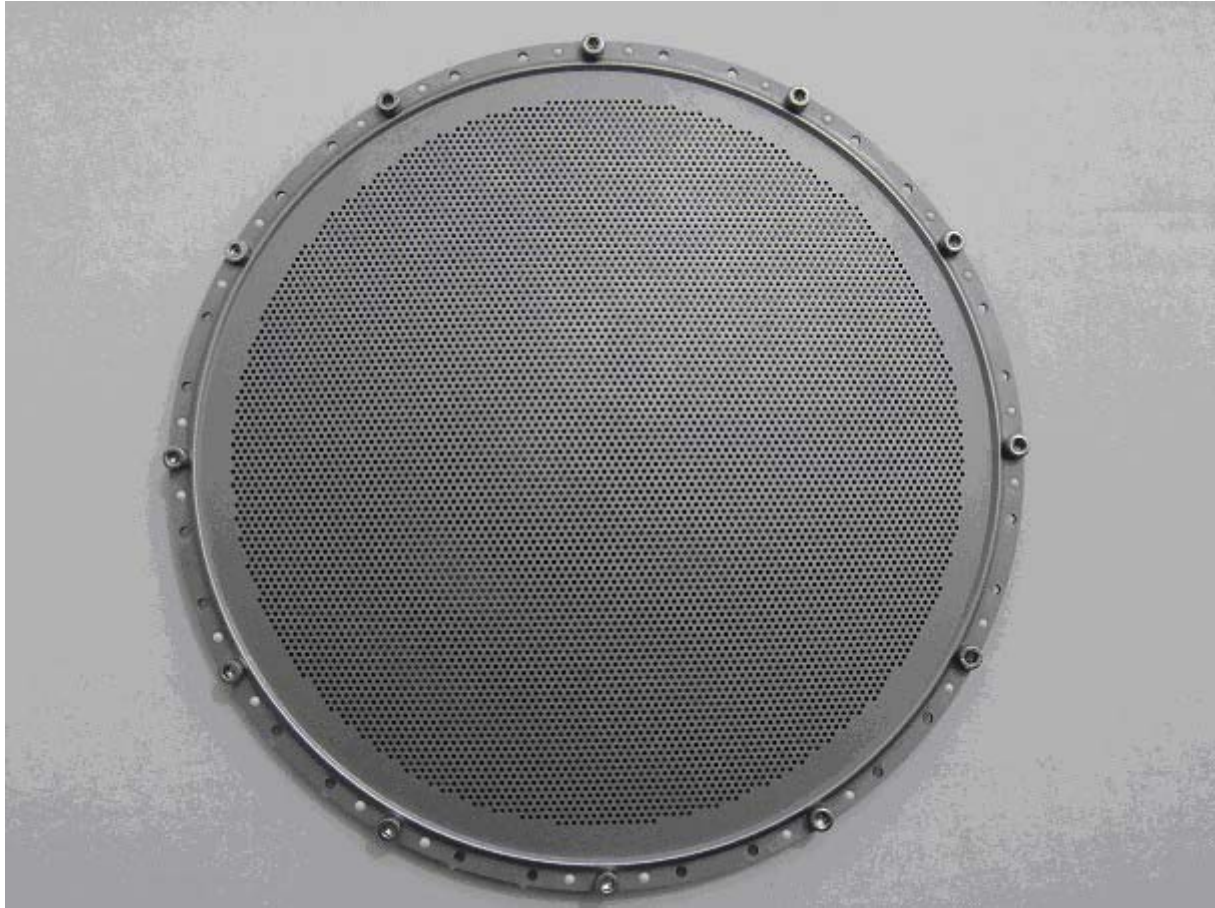
Abb. 27: 2-Gittersystem aus Molybdän mit selbstjustierender Montage komplett verschraubt für den Einsatz in einer ECR- Ionenstrahlquelle mit 200 mm Ionenstrahldurchmesser
