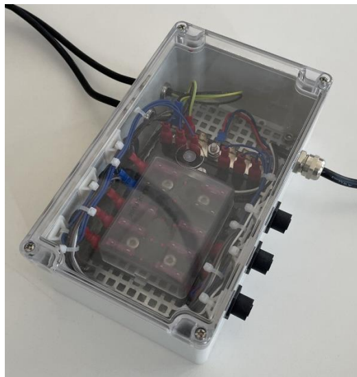
Abbildung 7: Stromverteilung der Komponenten (Eigenbau)
