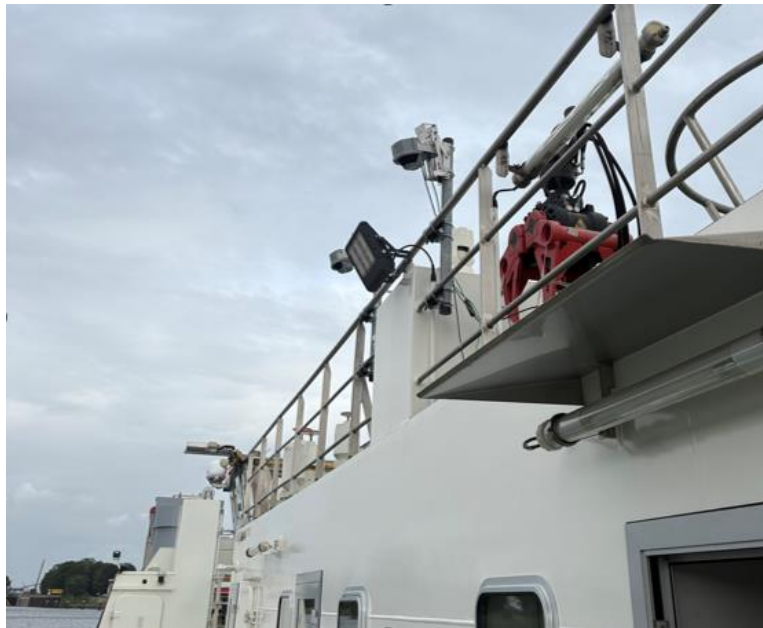
Abbildung 12: Montierte mittlere Sensoren auf der Steuerbordseite
