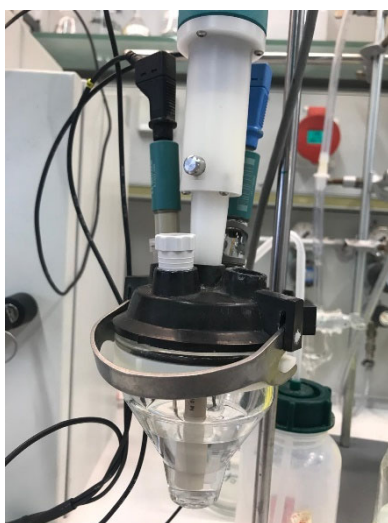
Abb. 2: Elektrochemische Messzelle und vorbereitete Elektroden (RDE) für die Wasseroxidation.
