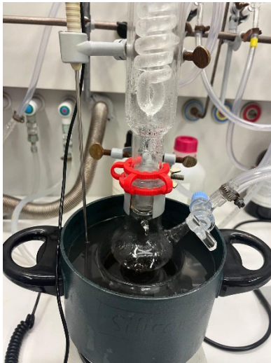
Abb. 1: Synthesepplatz und Klapprohfen für die thermische Behandlung.
