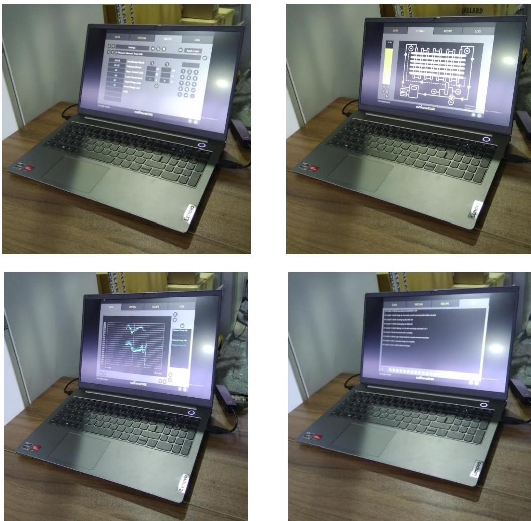
Abbildung 1-3-2-2: Modifizierte CultinovaEDGE-Software auf einem Windows PC zur Steuerung des Photobioreaktortemperierungssystem und des LED-Beleuchtungssteuerungssystem
