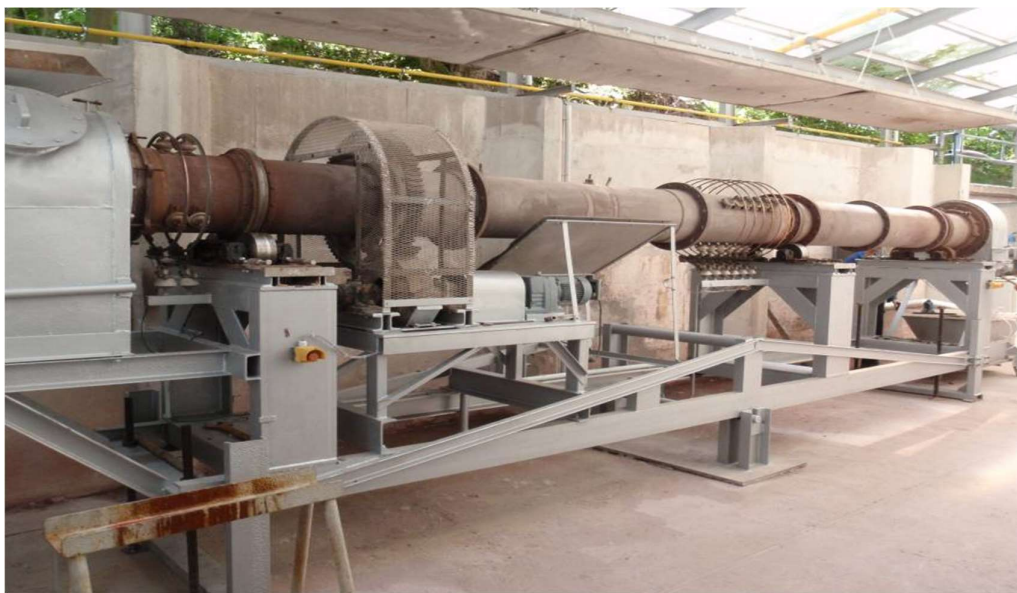
Abbildung 6: KDO Versuchsofen bei der IBU-tec in Weimar (7 x 0,3 m)
