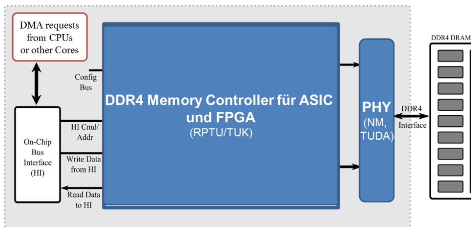
Abb. 7: DDR4 Memory Controller im DRAM-Subsystem
