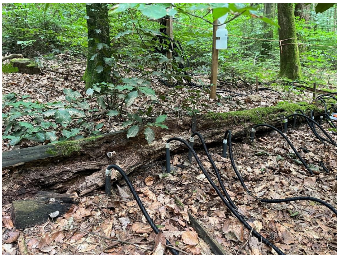
Abbildung 6: Einbau der Saugkerzen entlang des liegenden Totholzstammes. Foto: Lisa Rubin
