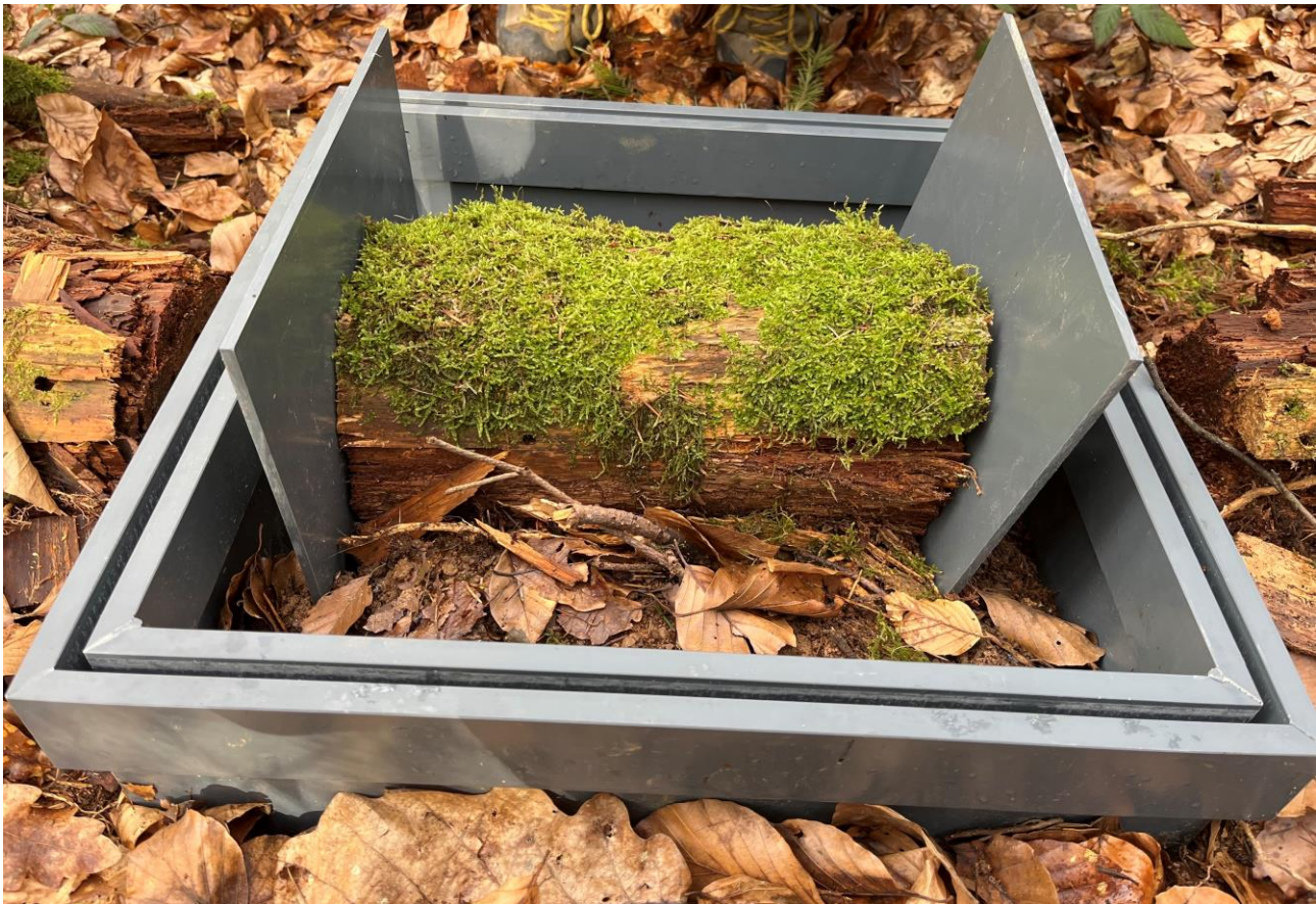
Abbildung 7: Basisrahmen für die Kammermessungen für den Kleinstandort Totholz. Foto: Lisa Rubin
