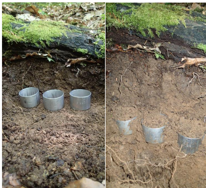
Abbildung 13: Fotos der Stechzylinderentnahme auf den Intensivmessplots. Fotos: Peter Stiasny
