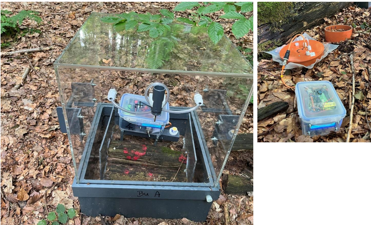
Abbildung 9: Im linken Foto ist die Messung der CO 2 -Flüsse über dem Totholzstamm zu sehen, im rechten Foto die Messungen direkt neben dem Totholzstamm (Randbereich). Fotos: Lisa Rubin
