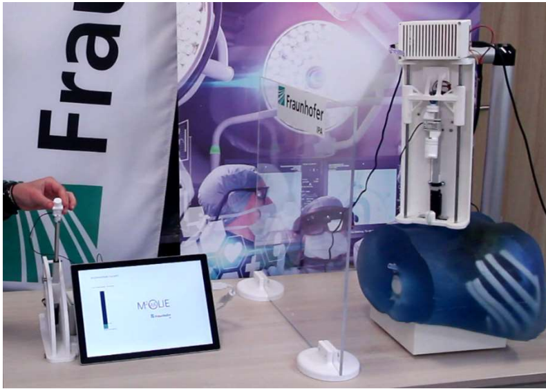
Abb. 5: Links: Kontrollpult mit Force-Feedback-Eingabegerät; rechts: Nadelaktuator an Stativ über Phantom
