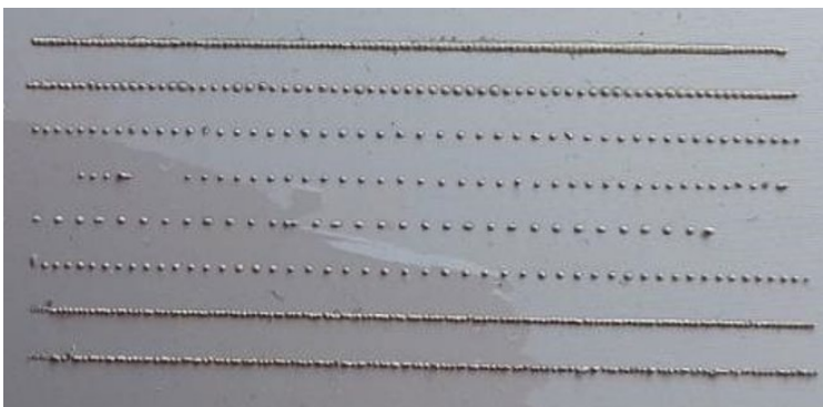
Abbildung 21: Erfolgreich Jetdispensversuche am ISC mit Lotpaste SAC305 T5 MJ21 84,4%
