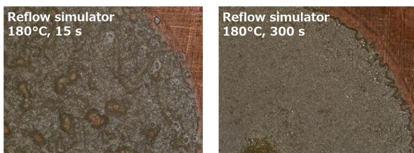
Abbildung 15: Einfluss der Lötzeit auf die Porosität; Röntgenuntersuchungen der Peel-Test-Proben (oben) und Benetzungsproben aus dem SMT Scope
