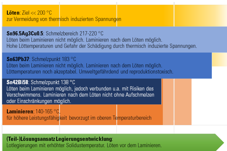
Abbildung 1: Schmelzbereich konventioneller Lotlegierungen im Vergleich zu Löt- und Laminiertemperaturen und mögliche Lösungsansätze
