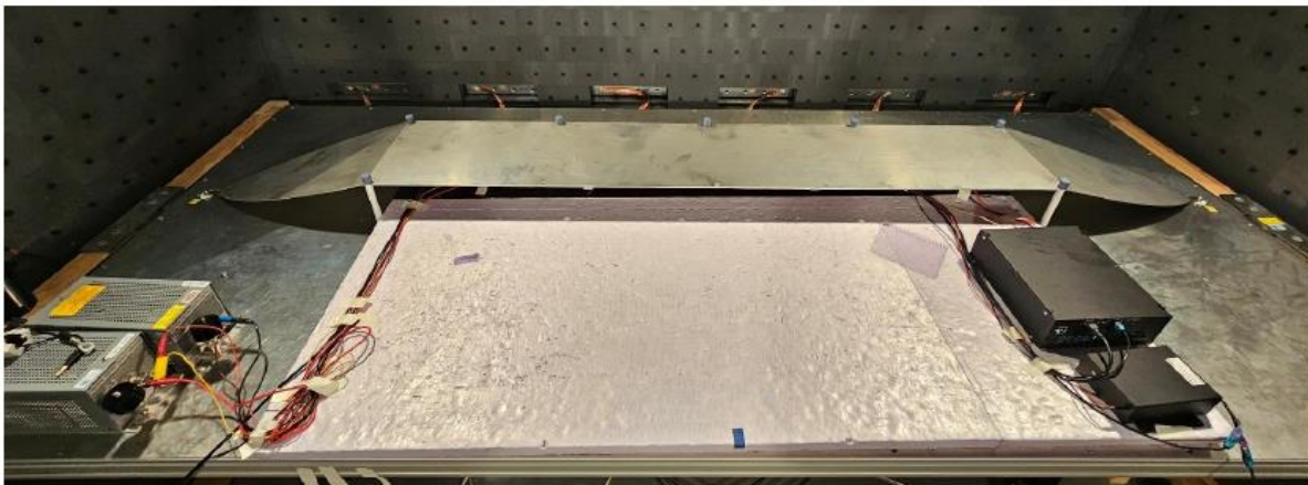
Abbildung 41: Konkreter Laboraufbau zur EMV-Messung
