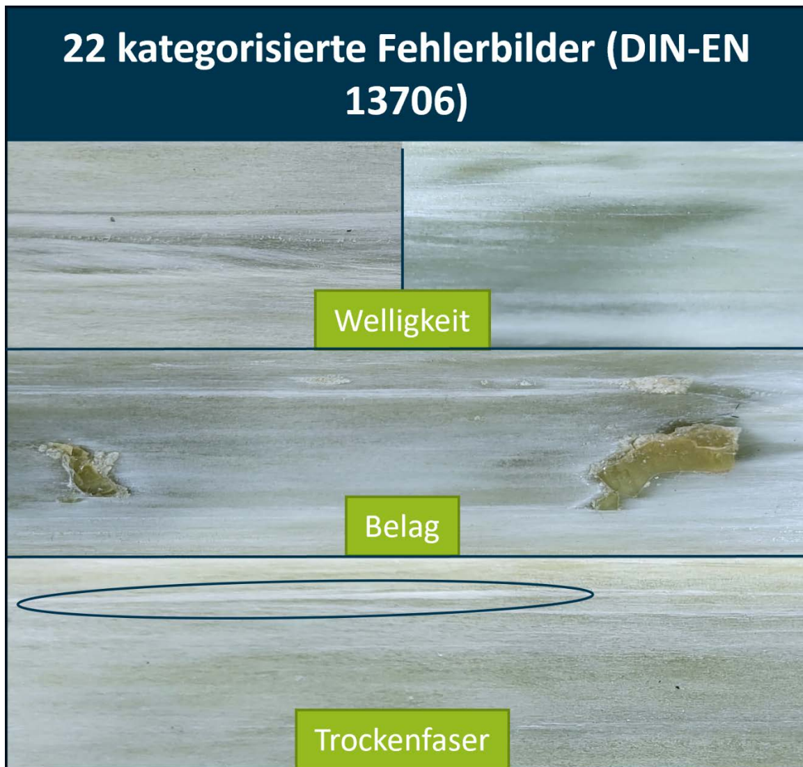
Abbildung 9: Beispielbilder für die untersuchten Fehlerklassen, Aufnahmen von Profilen die während des Forschungsvorhabens analysiert wurden
