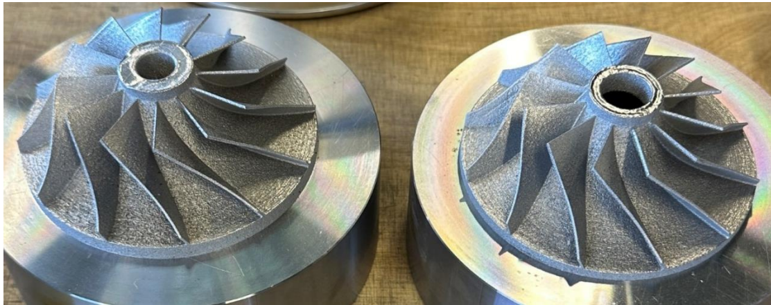
Abbildung 20: Additiv gefertigte Turboladerlaufräder aus der entwickelten Hochentropielegierung.
