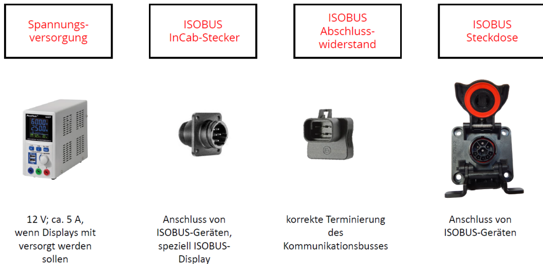
Abbildung 4: Komponenten für den ISOBUS-Laboraufbau
