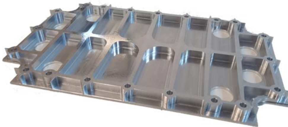
Abbildung 3: Foto der gefertigten gerippten Endplatte für den ESS.
