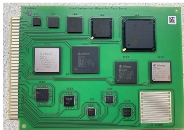
Abbildung 6: Testboard zur Bewertung der Underfiller und des Vergusses hinsichtlich elektrochemischer Migration
