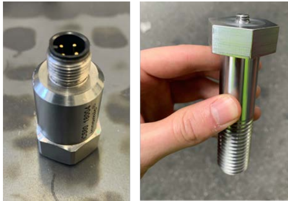
Abbildung 13: Darstellung des eingesetzten iCS80 / iCS84- Sensors (links) und der modifizierten Schraube zur Anbringung des Sensors (rechts).
