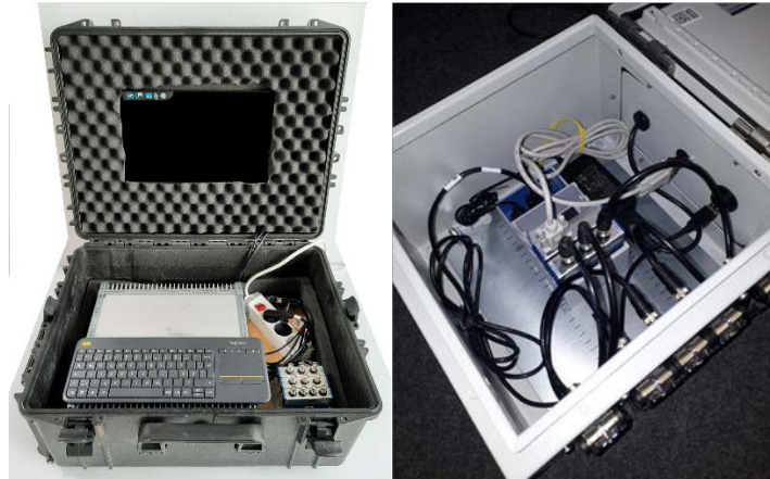
Abbildung 7: Messsysteme zur Messung im Prüfstandumfeld (links) und zur mobilen Messung im Hafenumfeld (rechts).
