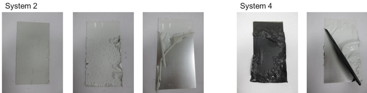
Abbildung 11: Abbildung der getesteten Beschichtungen nach Skydroleinlagerung nach 1.000 h bei 70 °C
