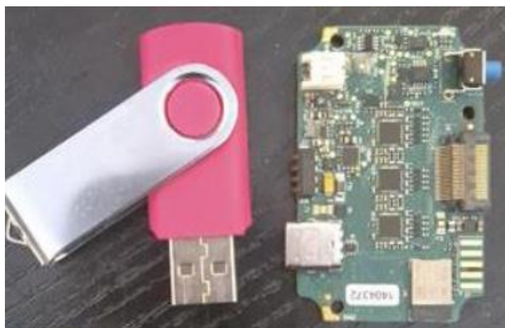
Abbildung 1: PCB Board der BCI Verstärkereinheit
