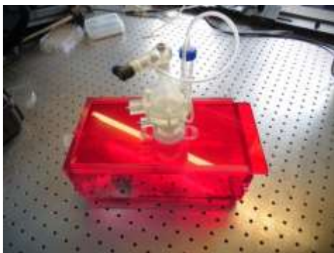
Abbildung 35: Mit der DBE-Plasmaquelle ausgerüstete Isofluran-Kammer für die experimentelle Behandlung von Kleintieren mit plasmabehandelter Luft
