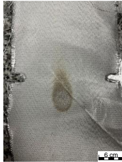
Abbildung 3: Brandmarke auf mit Flammschutzappretur veredeltem „KlevoGlass 550 V4A-1 L“ ohne Lochbildung
