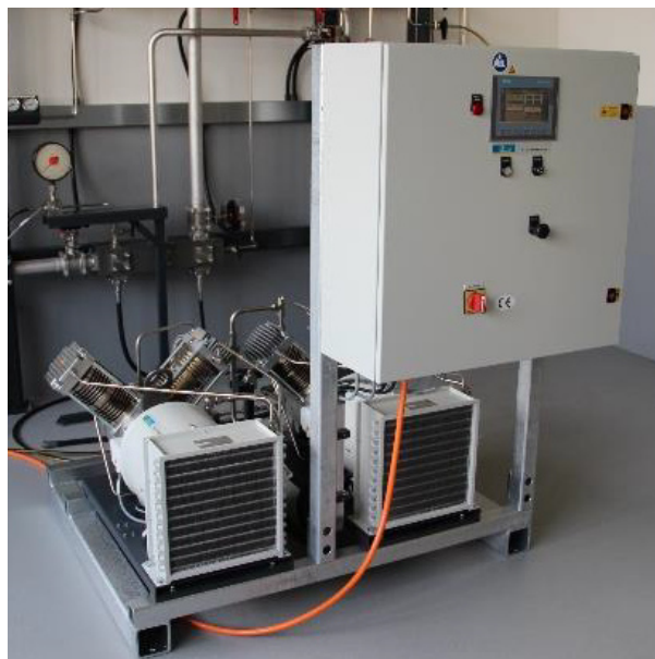
Abbildung 1: Zweistufige Xenon-Kompressoranlage als Computerzeichnung (links) und Foto bei dem Factory Acceptance Test (rechts).
