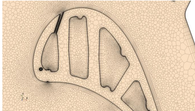
Abbildung 12: Schnitt durch das Netz der skalierten Turbinenschaufel
