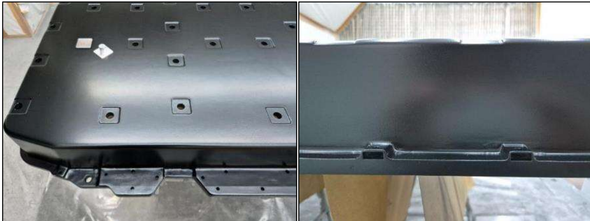
Abbildung 14: Komponentenfertigung der Wanne für den Recycling-Demonstrator
