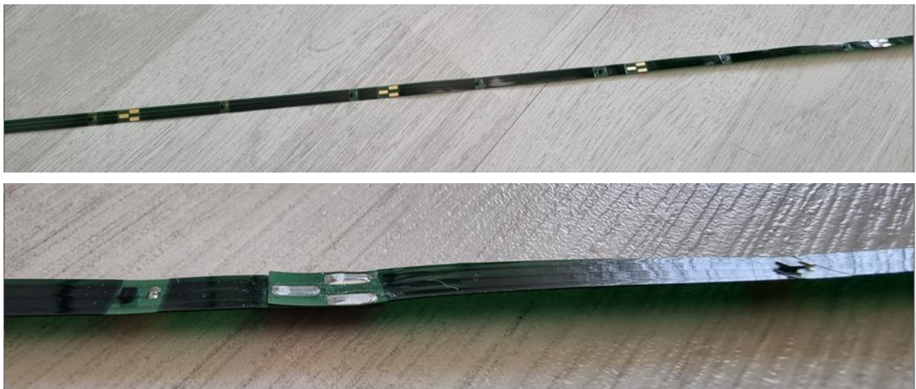
Abbildung 13: Langer Sensorstreifen aus kürzeren miteinander gelöteten Streifen; Quelle: Valmet
