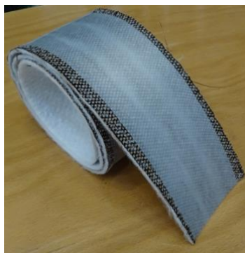
PLA-Gewebe/Vlies vernadelt nach dem Coatingprozess
