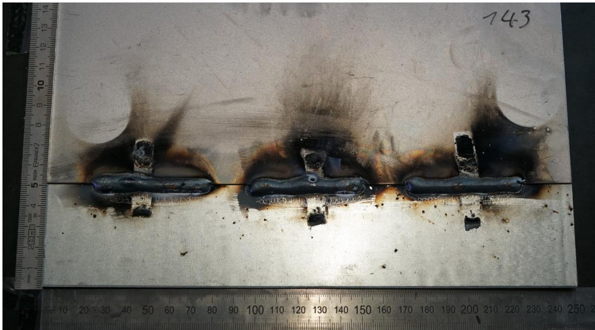
Abb. 11: Gezeigt werden hier drei WIG geschweißte Nähte zweier überlappender Bleche. Die Intensität wurde inmitten der Schweißung gesteigert, so dass Durchbrand (z.B. Loch in der mittleren Schweißnaht) bzw. zu Schweißraupenerhöhungen entstand. Die Schweißnähte wurden exemplarisch mit dem vorgestellten Laserabtastungsverfahren vermessen.
