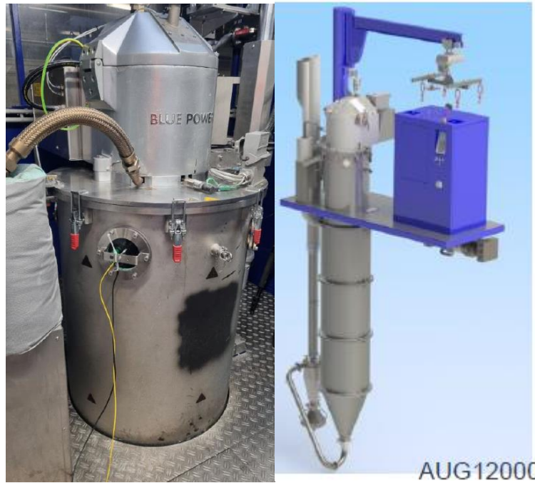
Abb. 8: Abbildung der Schmelzkammer und oberer Bereich der Verdüsungskammer (links). Am Prozessbetrachtungsfenster der Verdüsungskammer sind die Messsensoren appliziert. Rechts die Darstellung einer kompletten Verdüngungsanlage.
