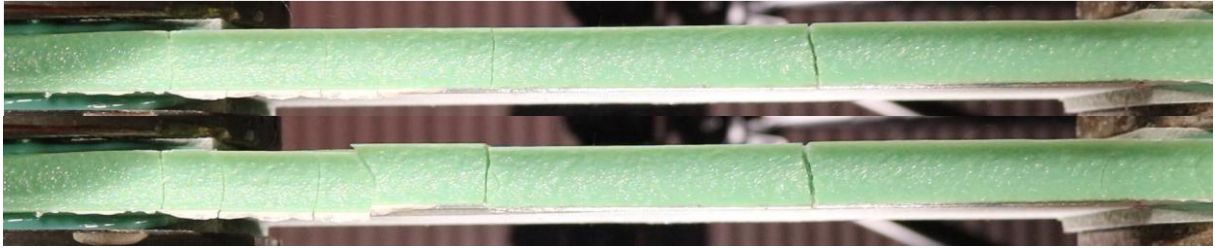
Abbildung 8: Schäden vorne an statisch geprüfter "Milchschnitte" bei F=282,9\text{kN} , 314,4\text{kN} und 395,7\text{kN}
