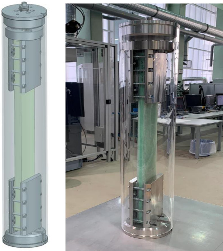
Abbildung 15: CAD-Darstellung und Abbildung der Aufziehvorrichtung im Technikum für repräsentative Hinterkanten-Verklebungsproben
