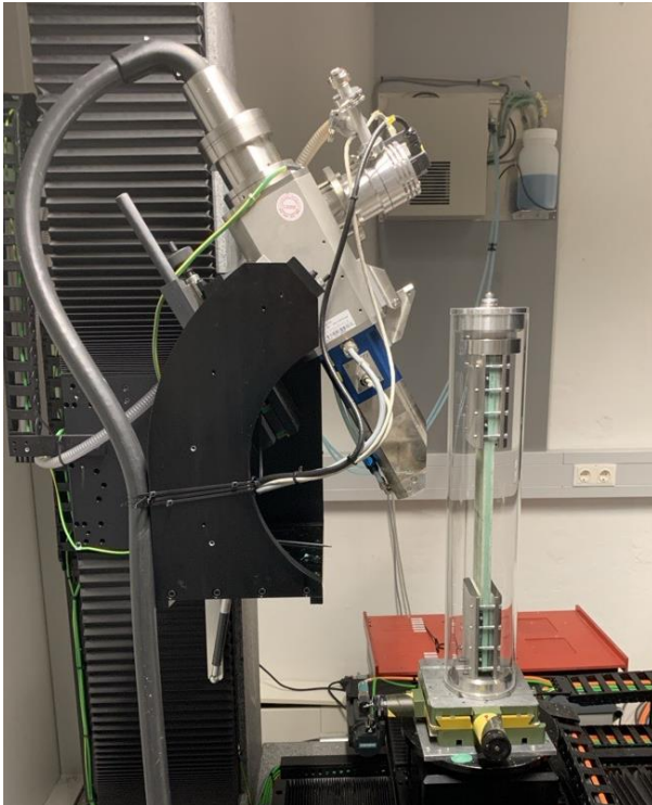
Abbildung 17: Meskammer zur Durchführung der CT-Messung mit Aufziehvorrichtung
