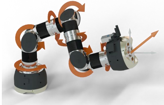
Abbildung 18: Qualitative Abbildung der aufsummierten Motormomente und berechneten Kräfte am TCP
