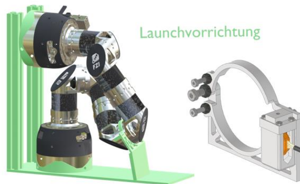
Abbildung 24: Launchposition und zusätzliche Klemme mit Frangi-Bolt
