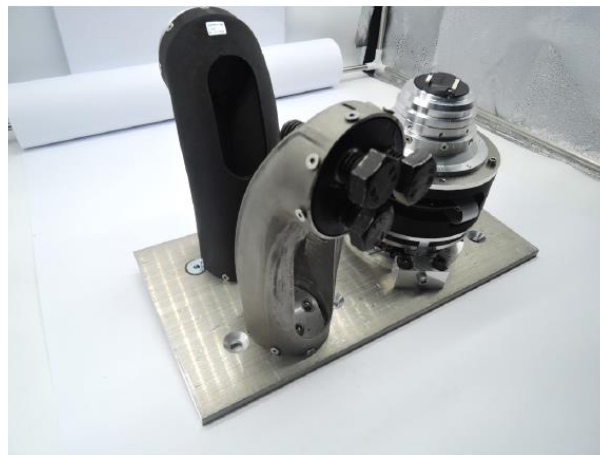
Abbildung 25: Testaufbau für den Random Vibration Test
