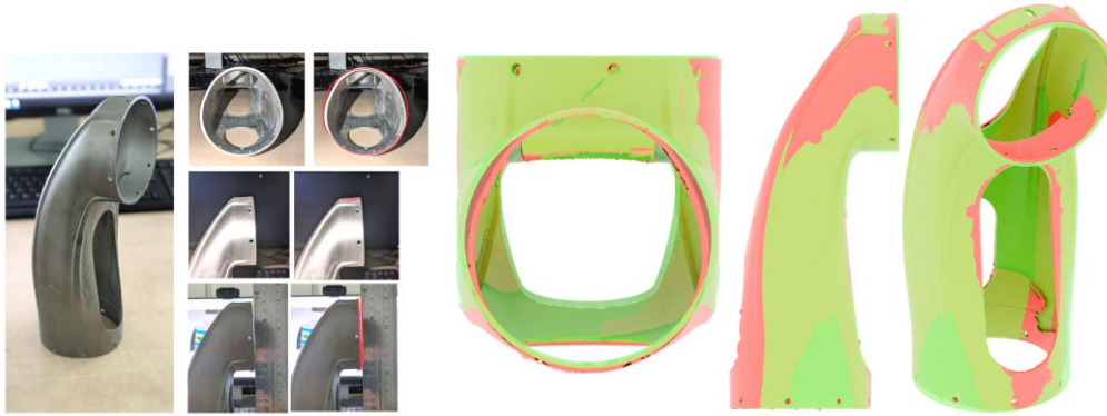
Abbildung 7: Abweichungen der 3D gedruckten Segmente
