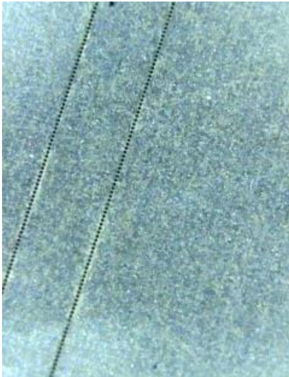
Abb. 7 CCD Aufnahme gelochte Linie in Titanfolie (6µm dick)
