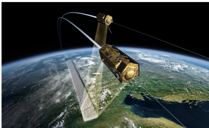
Abbildung 2-6: Bistatisches SAR System mit zwei Satelliten am Beispiel von TanDEM-X.
