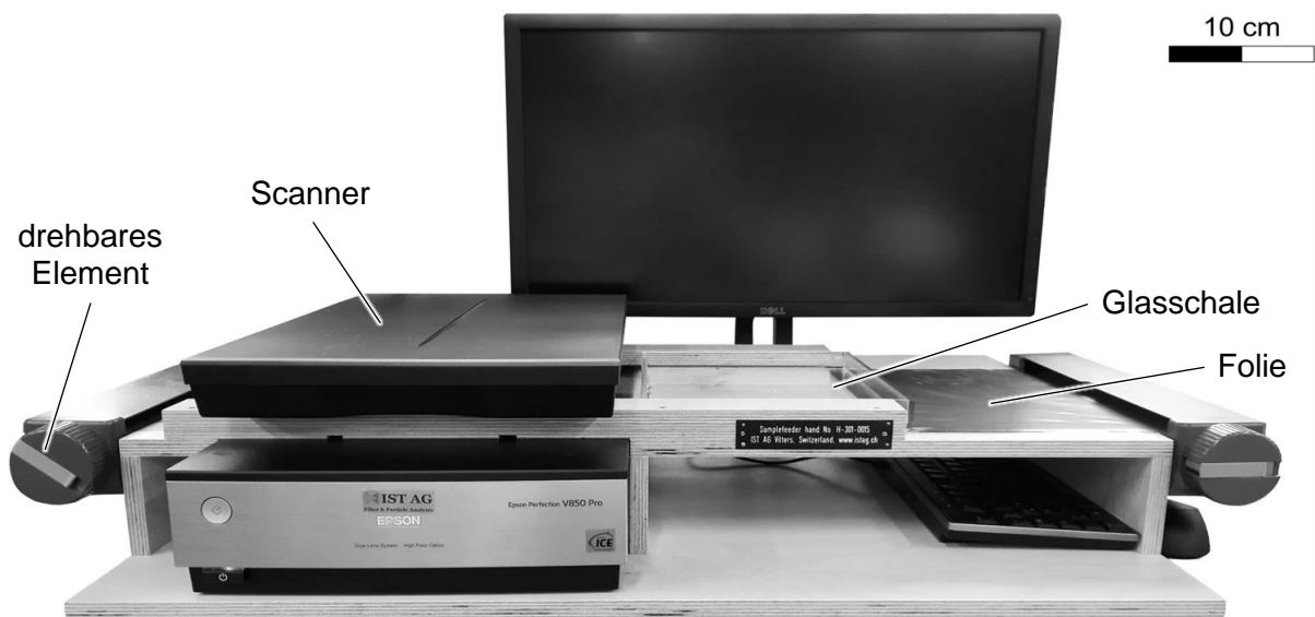
Bild 34: Prüfaufbau Faserlängenmessung fibreshape
