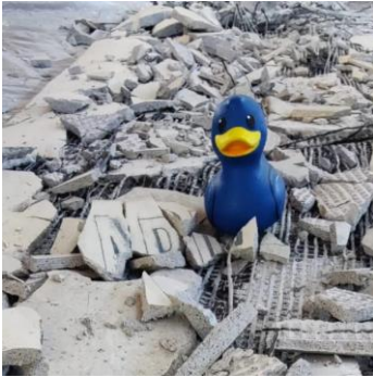
Bild 72: Zerbrochenes Betonkanu mit Textilfasergelege
