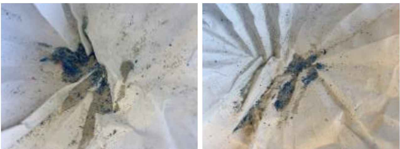
Bild 51: Schwimmende Rückstände der Carbonbeton Feinfraktion auf dem 0,063 (links) und dem 1 mm Sieb (rechts)
