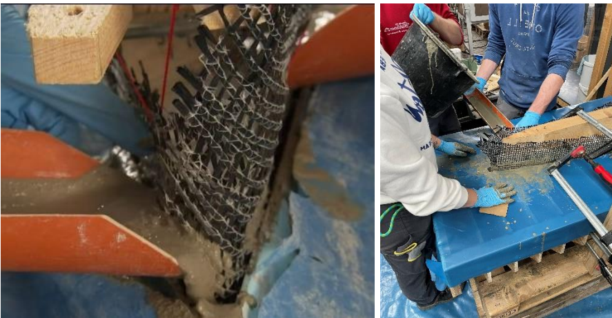
Bild 70: Herstellung Betonkanu, einfüllen des selbstverdichtenden Betons
