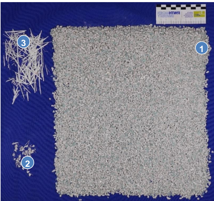
Bild 21 Bestandteile der untersuchten RC-GKG. > 4–8 mm 1. Betonbruch. 2. Betonbruch mit eingeschlossenen Faserresten. 3. Fasern
