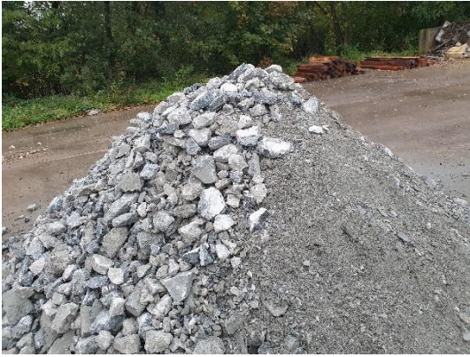
Bild 14: Mit mobilem Brecher aufbereitete CPC Reste 0/300
