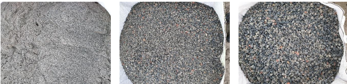
Bild 15: Mit Prallbrecher und Siebanlage hergestellte Körnungen aus CPC: links: 0/4; Mitte: 4/8; rechts: 8/16
