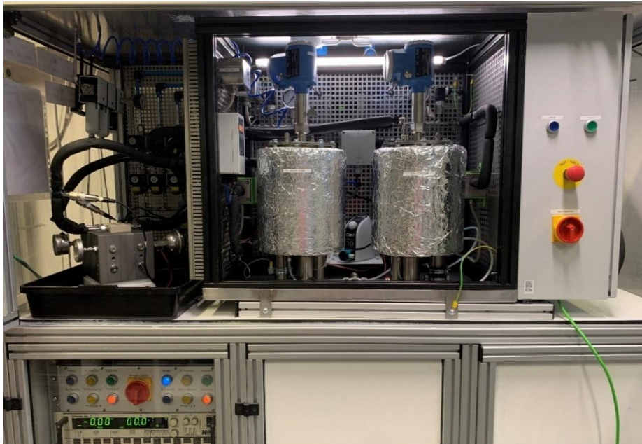
Abbildung 2: Testumgebung zur Charakterisierung von Aktivmaterialien im AEM-Elektrolysebetrieb.
