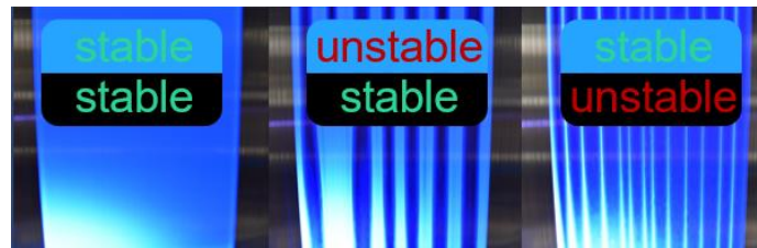
Abbildung 13: Fluideinfärbung und Defektsichtbarkeit am Beispiel eines stabilen Films (links), einer instabilen oberen Lage (mittig) und einer instabilen unteren Lage (rechts).
