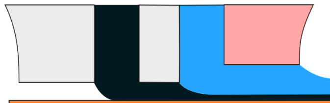
Abbildung 22: Schematische Darstellung eines Lippenversatzes der Downstream-Lippe.
