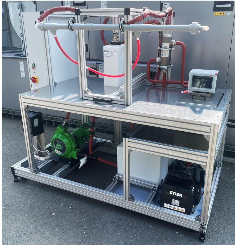
Abbildung 10: Pilotanlage zur Erprobung der beschichteten keramischen Membranen, welche vom Projektpartner IKTS entwickelt wurden.
