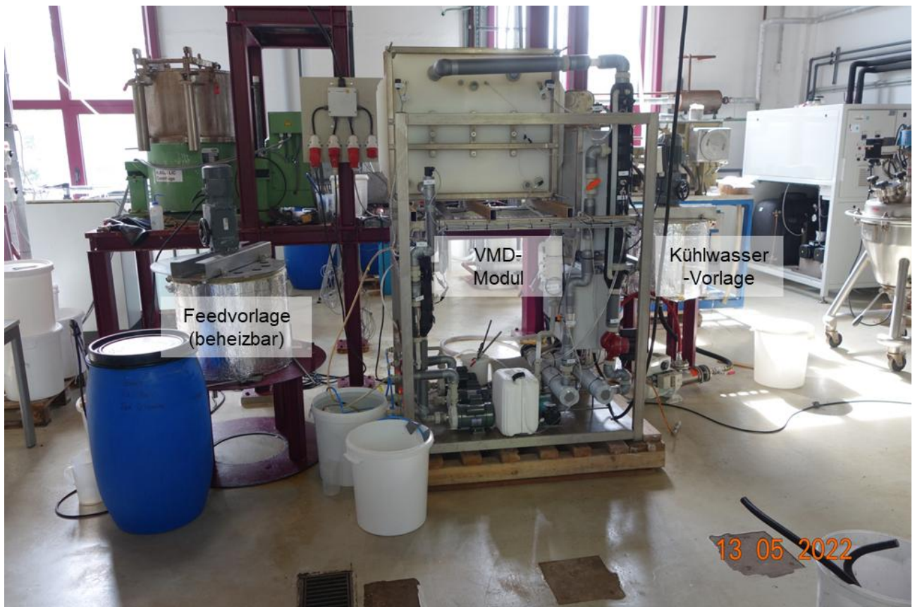
Abbildung 4: Versuchsaufbau zur Bestimmung der Triebkraft-Fluss-Korrelation für den VMD-Modulaufbau mit Leihmodul.
