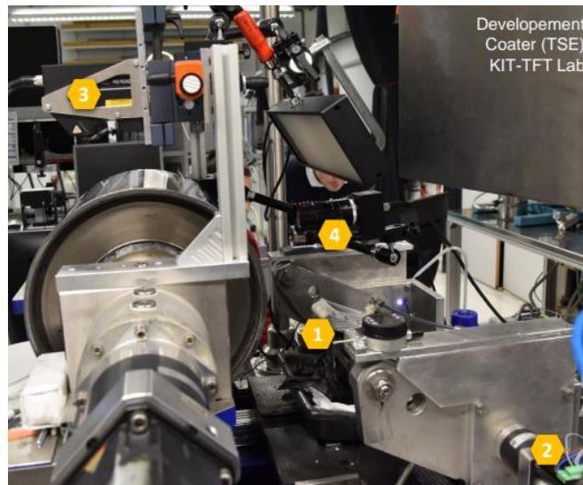
Abbildung 13: Aufbau mit Komponenten: 1 Schlitzdüse, 2 Stellmotor, 3 Triangulationslaser, 4 Zeilenkamera.
