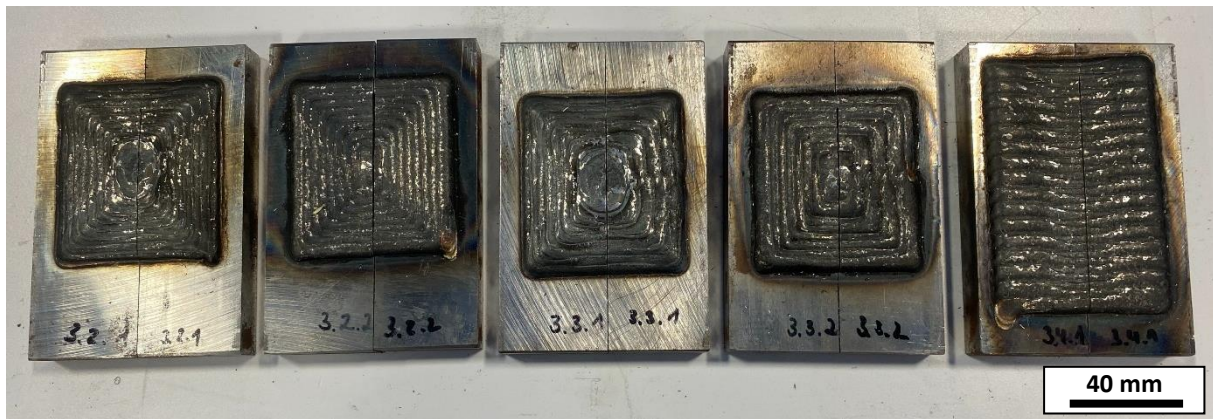
Abbildung 11: Flächige WAAM-Bauteile, die mit unterschiedlichen Bahnstrategien aufgetragen worden sind.
