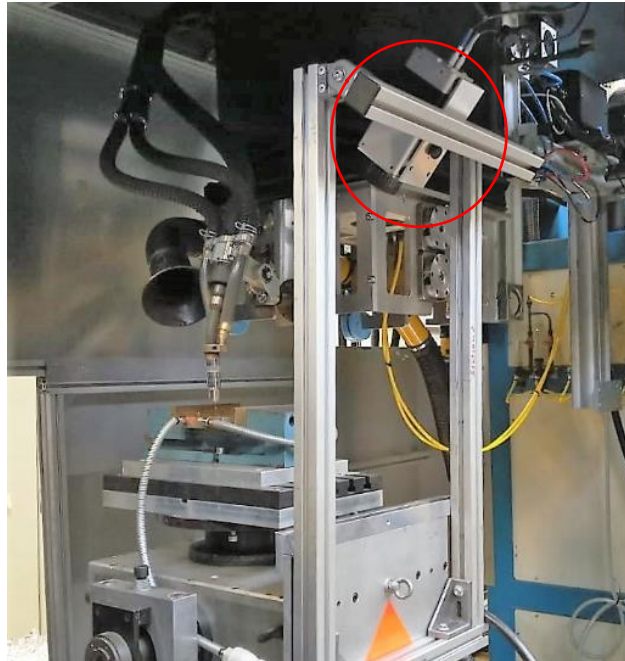
Abbildung 5: Bearbeitungszone der WAAM-Anlage mit montiertem Thermografiesystem (roter Kreis).
