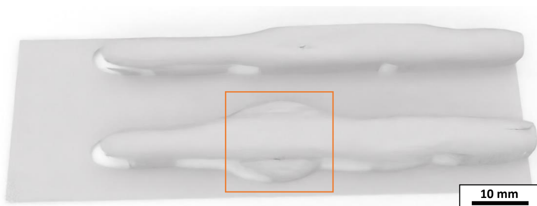
Abbildung 7: Aufnahme des Laser-Profil-Sensors zweier Schweißbahnlagen. Im markierten Bereich hat eine Verformung durch zu hohe Wärmezufuhr stattgefunden.
