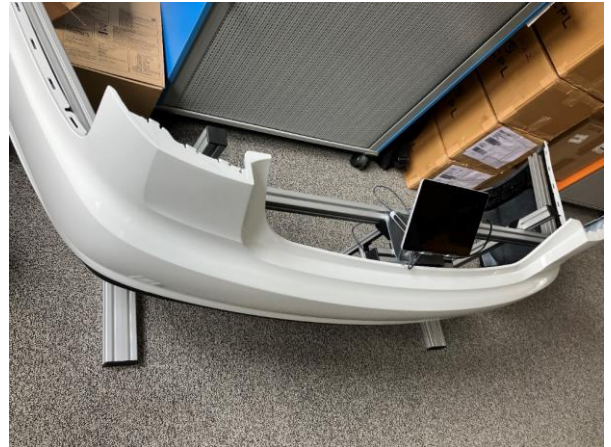
Abbildung 10: SC6 Laboraufbau für den KI- und Radar-basierten Kofferraum-Öffner
