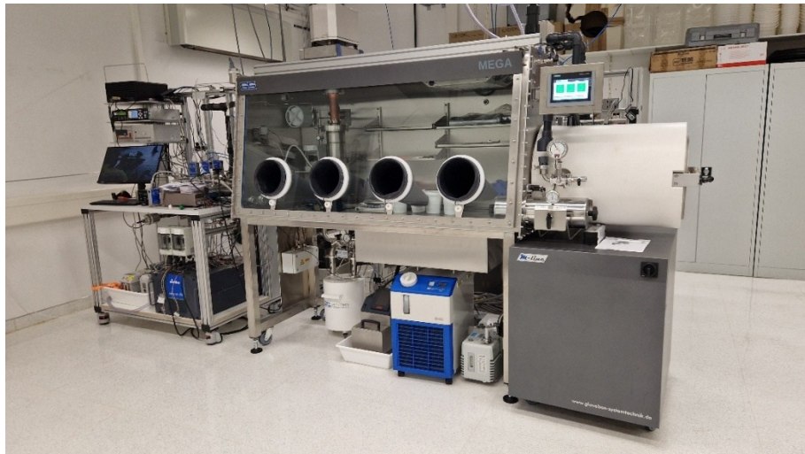
Abbildung 4: Gesamtansicht der Versuchsanlage. Glovebox mit eingekoppelter Magnetschwebewaage und links davon der Labortisch mit Arbeitsplatz und Anlagenperipherie.
