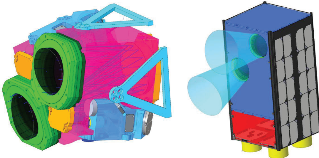
Abbildung 3: links: vorläufiges Design der optischen Payload zur Dual-Downlink-Quantenschlüsselverteilung. Rechts: Optische Payload in 16U-Envelope.
