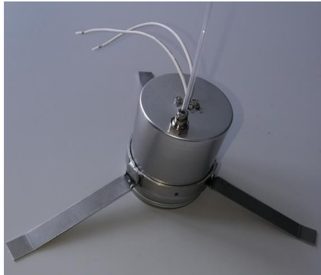
Abb.25: Versuchsmuster Feststoffprobenahme-Modul mittels Thermodesorption
