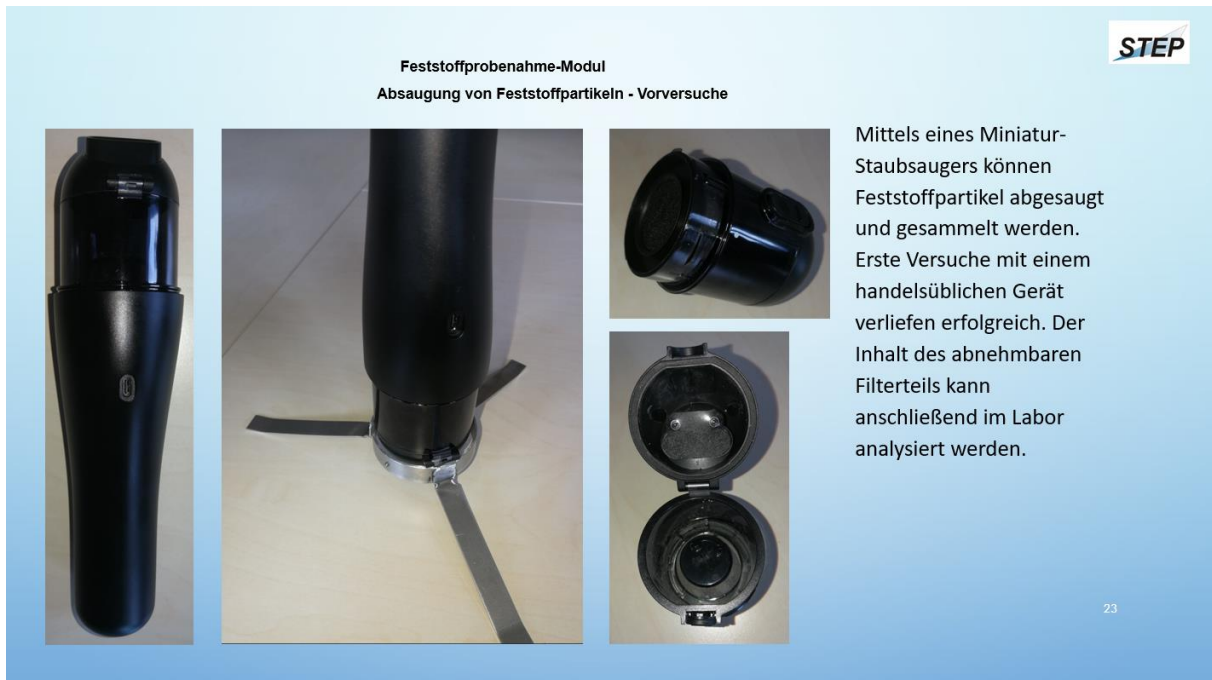
Abb. 28: Feststoffprobenahme durch Absaugung von Feststoffpartikeln
