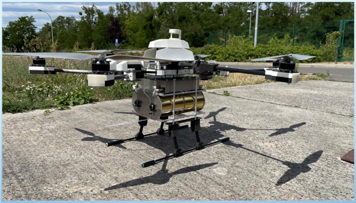
Abb. 8: Versuchsmuster Luftprobenahme-Modul (Variante 4-Beutel) an Drohne von Tholeg
