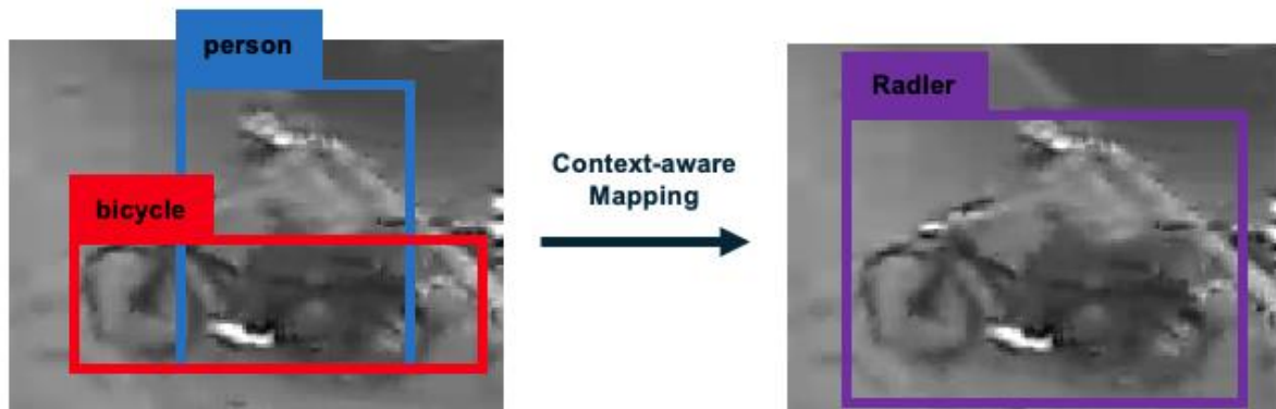
Abbildung 6: Darstellung der kontextbasierten Fusion von Objektklassen. Links zeigen farbige Bounding Boxes (Rechtecke zur Lokalisierung erkannter Objekte) eine Person (blau) und ein Fahrrad (rot). Rechts ist das Ergebnis der Fusion als einzelner Verkehrsteilnehmer Radler (violett) dargestellt.
