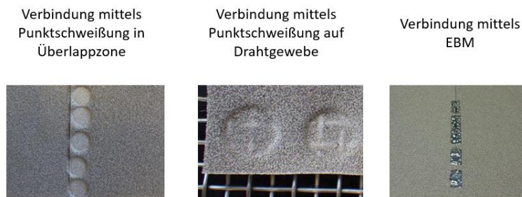
Abbildung 10: Vorexperimente der Verbindungstechnik zur Herstellung mehrerer PM-Elektroden-Segmente zu einer \varnothing 150 cm Elektrode.
