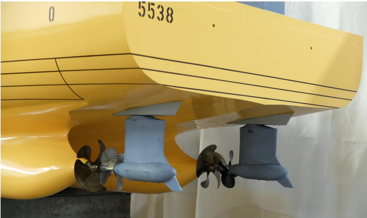
Abbildung 14: ULCS als Twin-CRP-POD mit modifiziertem Hinterschiff und verkleinerten Headboxen
