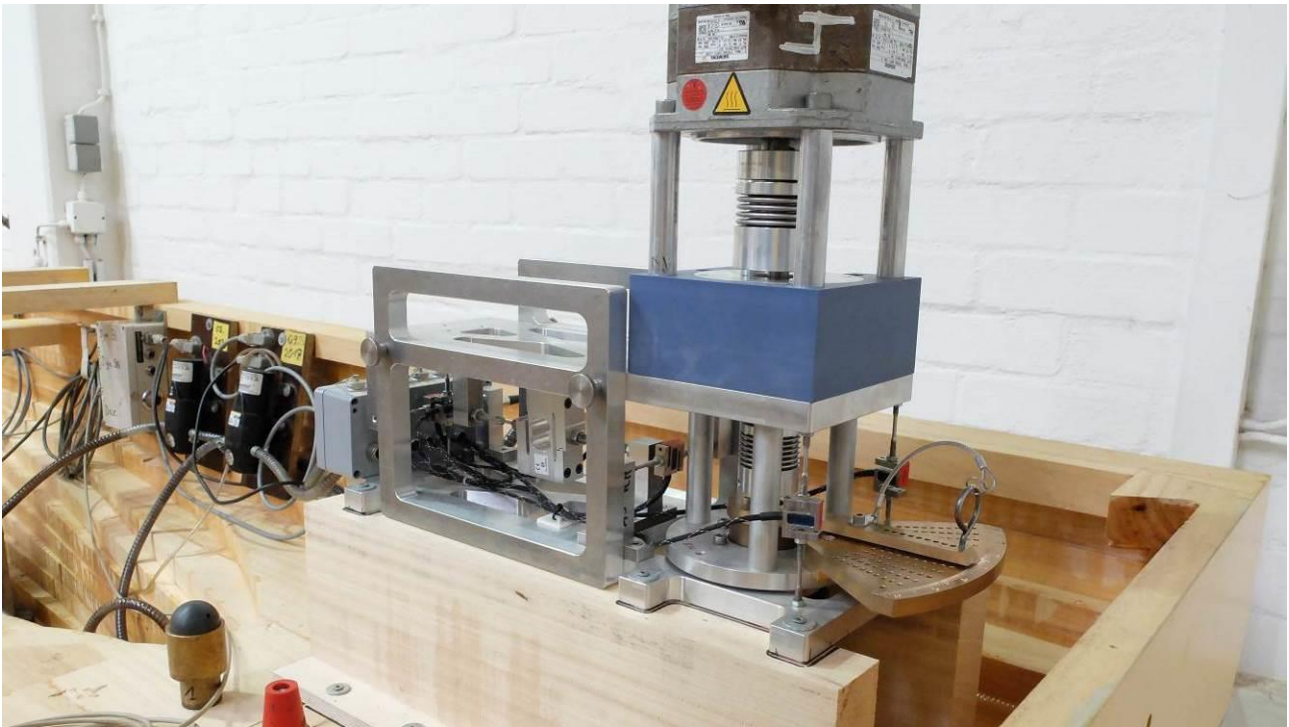
Abbildung 4: Aufbau der POD-Messeinrichtung für die Propulsionsversuche im großen Schlepptank
