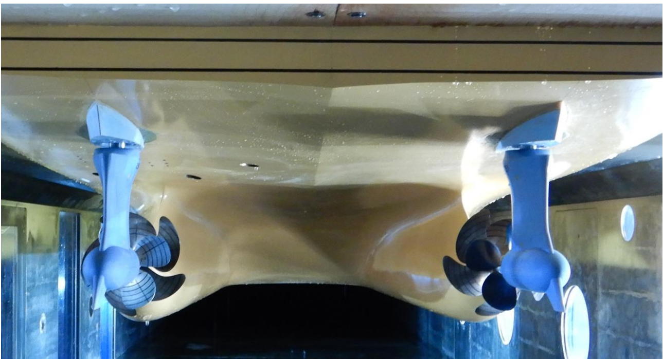
Abbildung 18: Installation des optimierten Hinterschiffes im HYKAT
