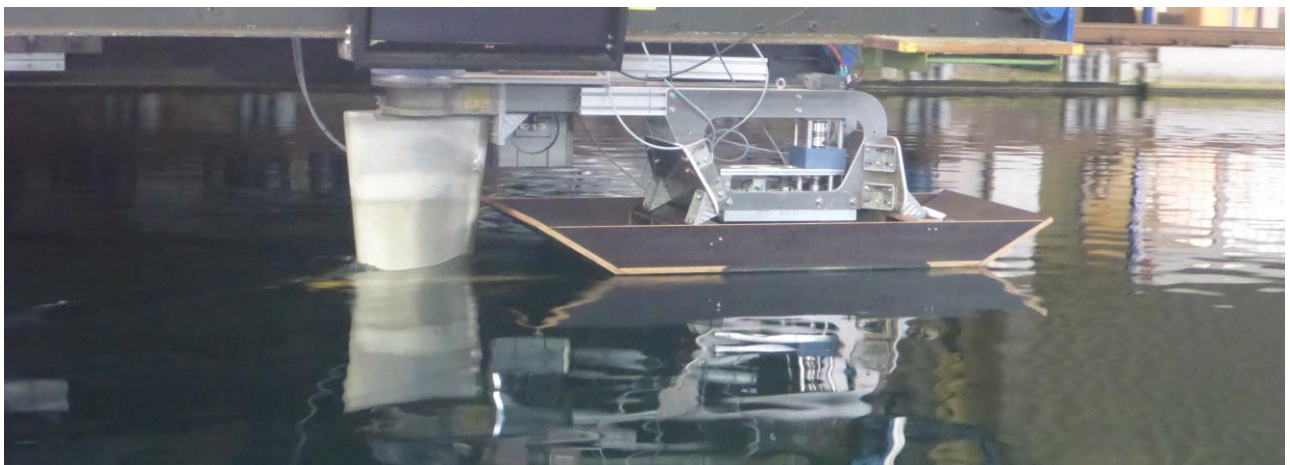
Abbildung 7: Versuchsaufbau der CR-POD Freifahrten unter dem Schleppwagen
