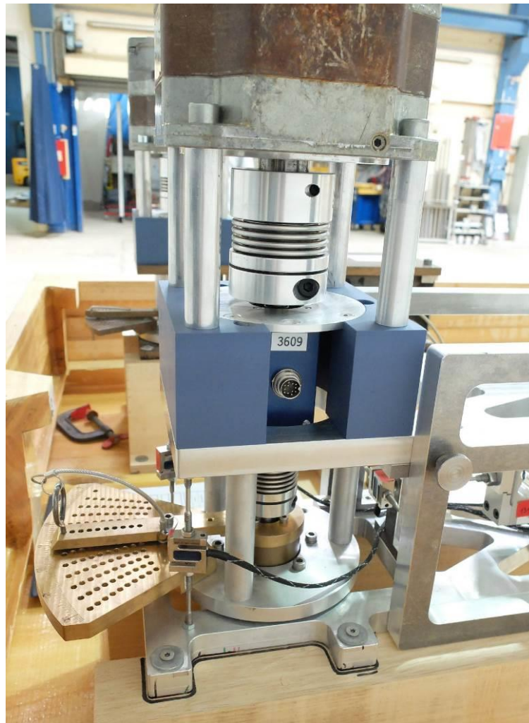
Abbildung 5: Detail der Einbindung des Drehmomentenmessgliedes in den Antriebsstrang des PODs
