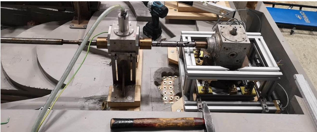
Abbildung 3: POD-Schubmesswaage im eingebauten Zustand mit vorgeschalteter Drehmomentenmesseinrichtung im Modell
