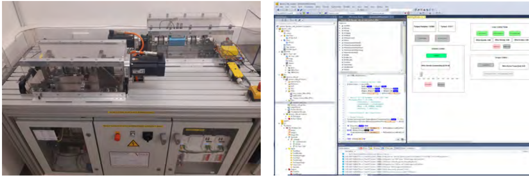
(a) Prüfstand mit Prüfling in der 50-Nm-Prüfstrecke.
