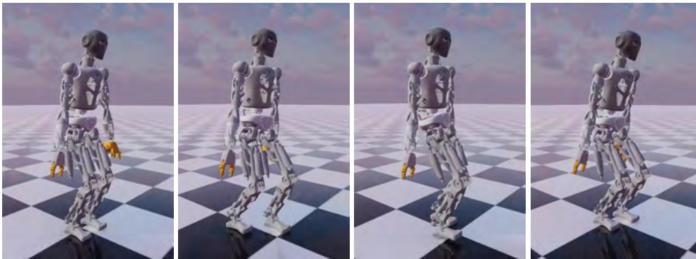
Abbildung II.14: Von rechts nach links: RH5 bei der Ausführung eines dynamischen Laufs in einer simulierten Umgebung mit WBC.
