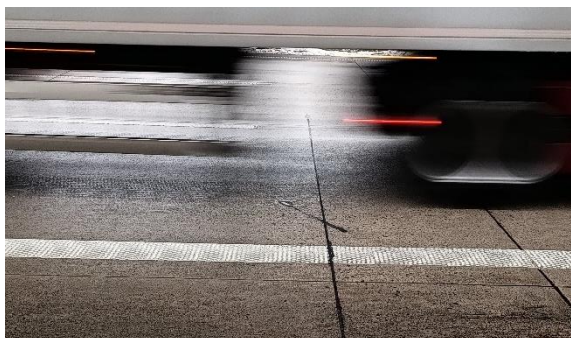
Abbildung 25 - Fahrbahnsensoren zur Messung des Salzgehaltes des Flüssigkeitsfilms
