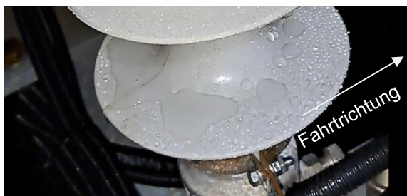
Abbildung 31 - Hydrophobieigenschaften eines Referenzisolators in Abhängigkeit der Fahrtrichtung
