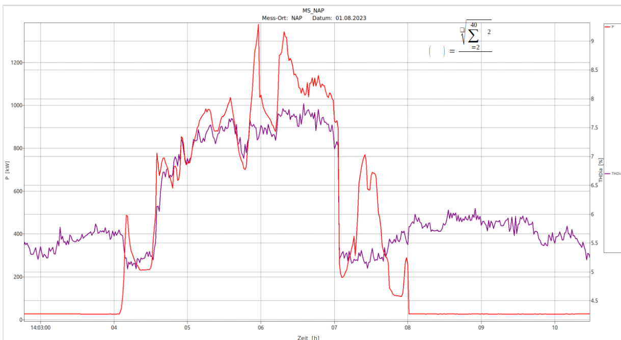
Abbildung 38 - Wirkleistung und Total Harmonic Distortion Faktor des Stroms (THDia) im NAP
