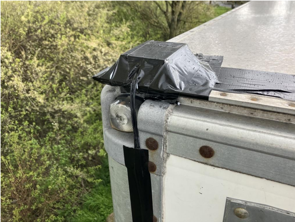
Abbildung 16 - Ansicht der auf dem Trailer temporär angebrachten Neosid 3D-Spule
