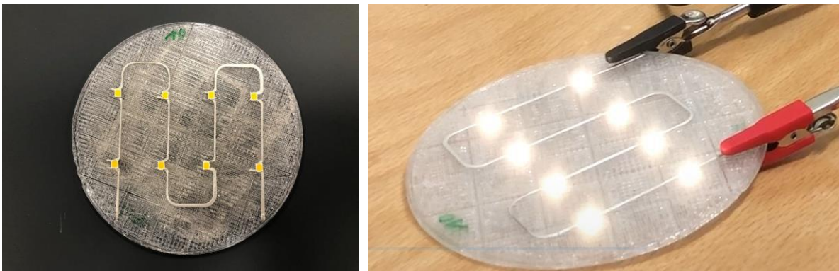
Abbildung 14 Kontaktierung einer dosierten Mäanderstruktur mit 8 integrierten LEDs
