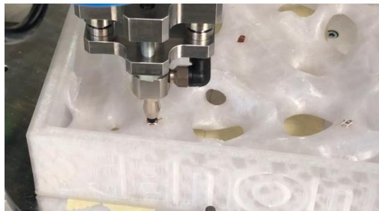
Abbildung 27 Vollautomatisches Bestücken der Basisform mit LEDs
