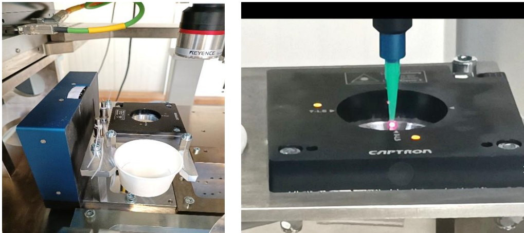
Abbildung 21 Links: Servicestation für Dosierwerkzeug; Rechts: Laserkreuz zur Nadelspitzenkalibrierung im XYZ-Raum
