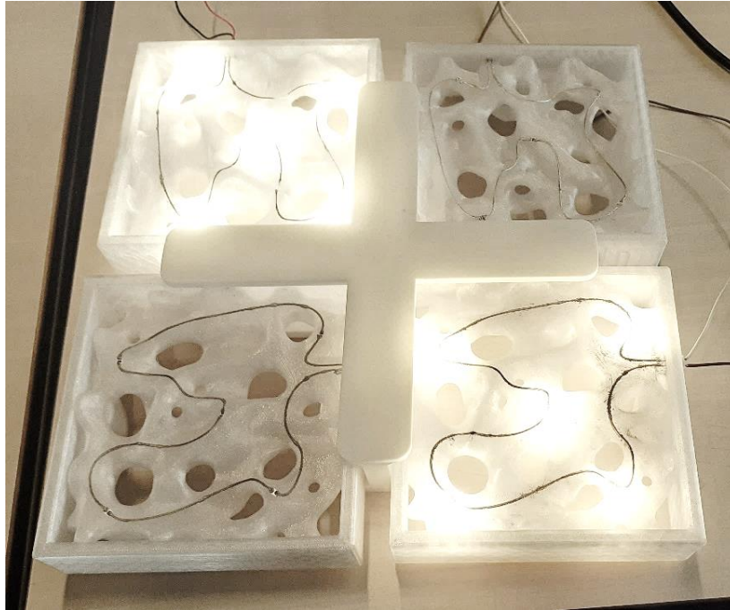
Abbildung 29 Verschaltete 4-fach Luminaire [Quelle: signify]
