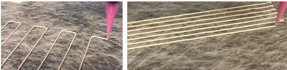
Abbildung 11: Vordosierversuche auf Fiberglas-Substrat. Links: Mäander; Rechts: parallele Linien.
