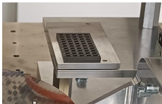
Abbildung 23: Flachbettwanne mit Taschenreihen zur Bereitstellung von LEDs in Pick&Place-Prozessen
