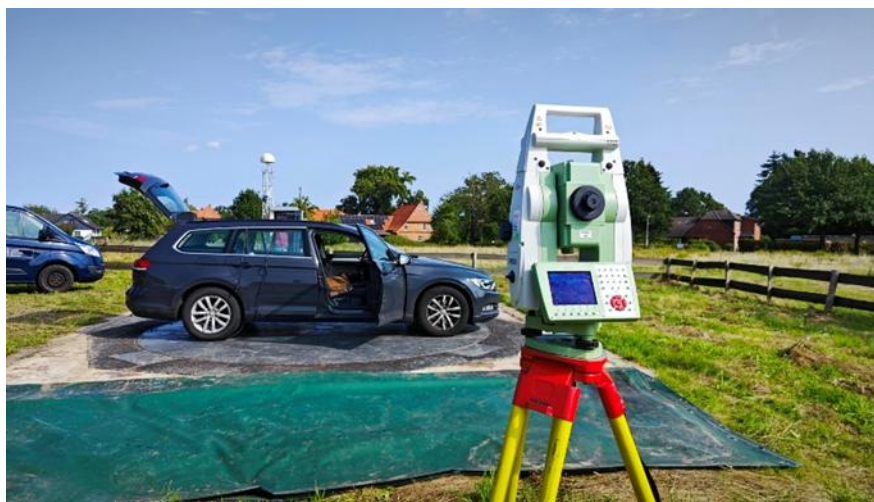
Abbildung 31: Eingesetztes Tachymeter zur Erzeugung eines digitalen Zwillings der Geo++ Kalibrierplattform
