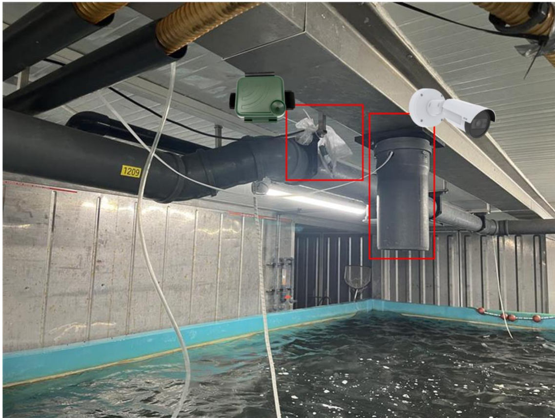
Abbildung 1: Installation der Hardwarekomponenten (Mikrofon- und Kamera Setup)
