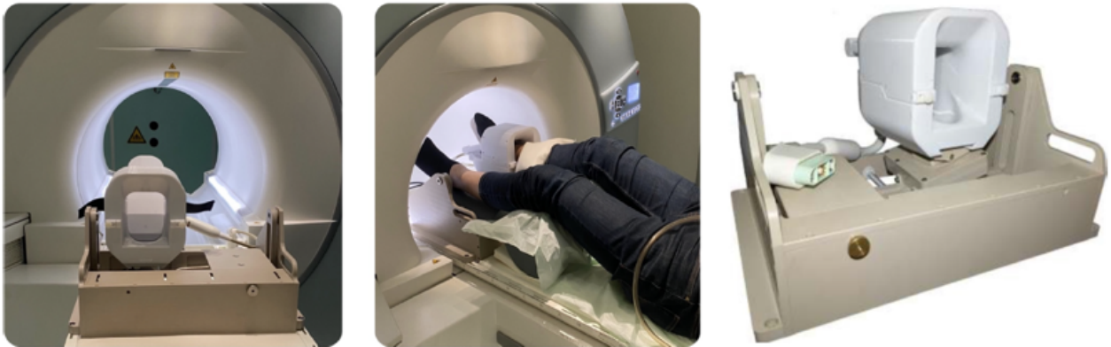
Abbildung 2: Das RAMI-Gesamtsystem (BeApp mit integriertem 16-Kanal-Detektor) im klinischen Einsatz. Links: Positionierung auf dem MRT-Patiententisch. Mitte: Einfahrt in die Scannerbohrung eines 1,5 T Siemens-MRT. Rechts: Gesamtansicht des Systems.
